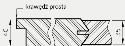
Przekrój poziomy drzwi Elsa
