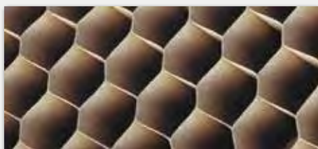
(A) Wkład stabilizujący „plaster miodu”
