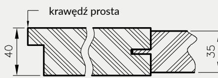
Przekrój poziomy drzwi Ena, Verano i Triesta (przekrój na wysokości ramiaka przy dużej szybie)
